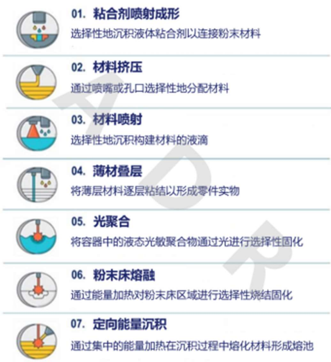
图 七种行业认可的增材制造工艺
